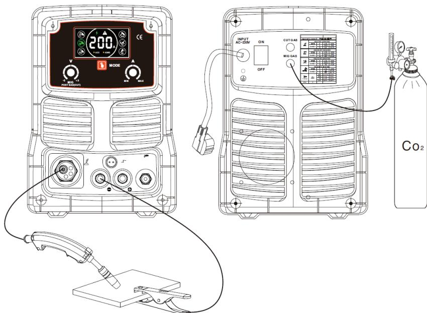
Kun avaat luukun ja asetat MIG-langan (kaasu: CO<sub>2</sub>) paikalleen, tarkasta seuraava liitännä. Se on liittäävä positiiviseen napaan (+).
