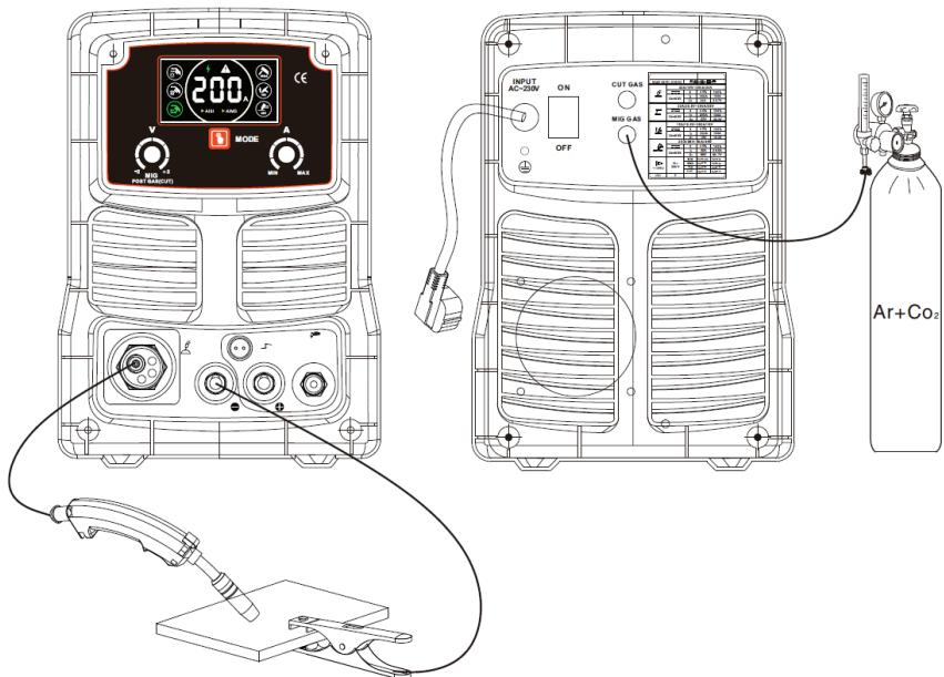
Kun avaat luukun ja asetat MIG-langan (kaasu: Ar+CO<sub>2</sub>) paikalleen, tarkasta seuraava liitännä. Se on liitettävä positiiviseen napaan (+).
