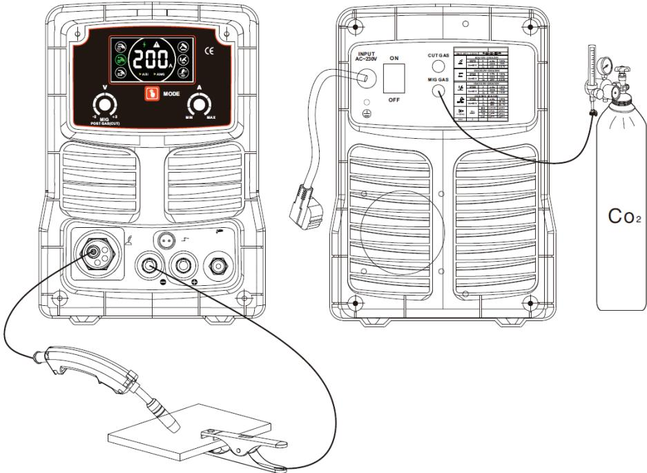
När du öppnar luckan och sätter in MIG-tråden (gas: CO<sub>2</sub>) ska du kontrollera följande anslutning. Den måste anslutas till den positiva polen (+).
