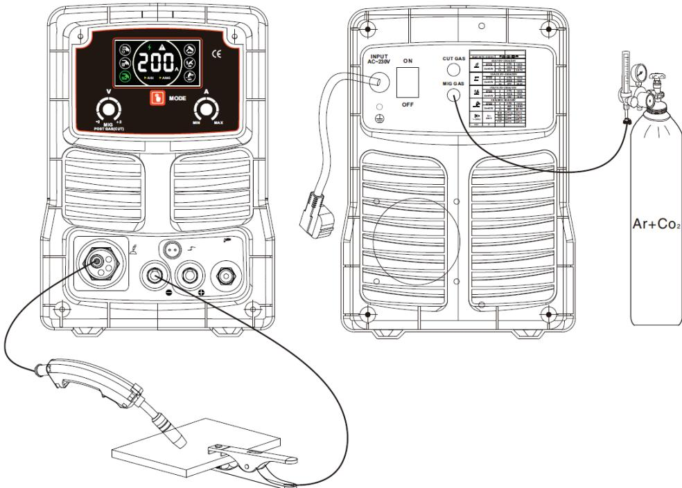
När du öppnar luckan och sätter in MIG-tråden (gas: Ar+CO<sub>2</sub>) ska du kontrollera följande anslutning. Den måste anslutas till den positiva polen (+).
