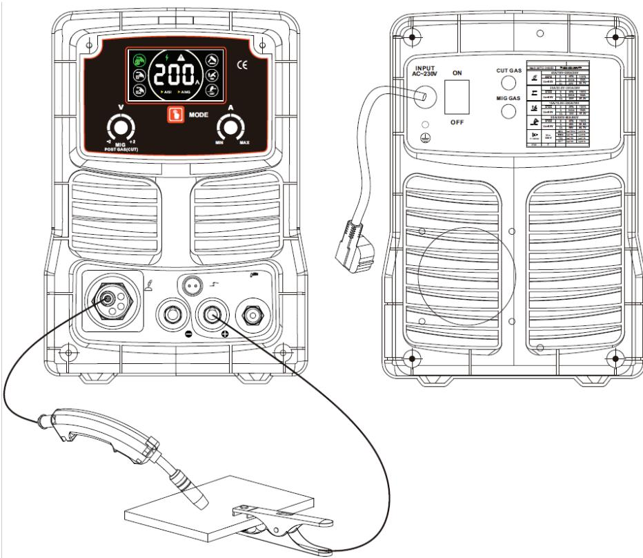
Kun avaat luukun ja asetat juoksuteytimellä varustetun MIG-langan paikalleen, tarkasta seuraava liitintä. Se on liitettyä negatiiviseen napaan (-).
