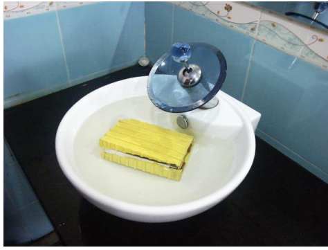
Lägg den oskyddade cellen i vatten
