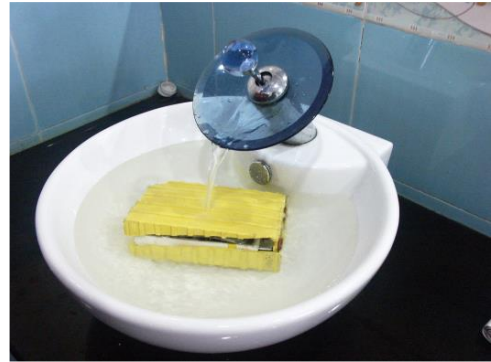
Suojaamaton kenno kastuu täysin
