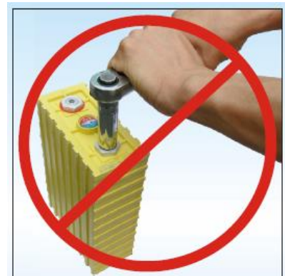
Dra inte åt skruven på polen för hårt.
