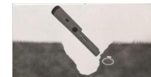
Om du inte får något svar inifrån hålet eller från jord/plugg som togs bort, är föremålet sannolikt djupare ner i Jord eller djupt inne i kontakten - bortom pinpointing-räckvidden. Svep med din marksökningsdetektor igen för att bekräfta där objektet är.
