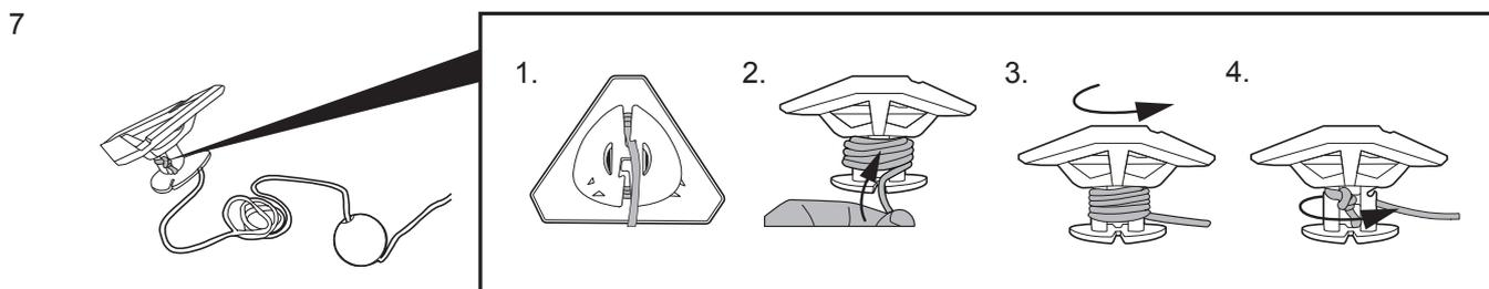
**Примечание.** Подденьте, чтобы отсоединить, крышку поплавка и отмотайте трос на длину, равную глубине воды в бассейне плюс около 0,5 м (19,7 дюйма).
