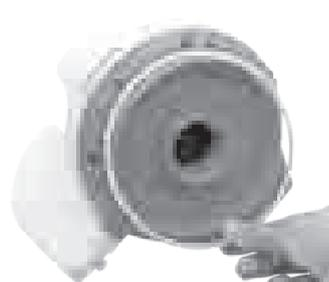
2. Użyć wkrętaka do odkręcenia 4 wkrętów znajdujących się w dolnej części głowicy, aby najpierw zwolnić płytę dolną. Użyć wkrętaka do odkręcenia wszystkich wkrętów podstawy, tak jak pokazano. Wymontować wirnik, a następnie podważyć podstawę i zdjąć ją, aby odsłonić wnętrze głowicy.
