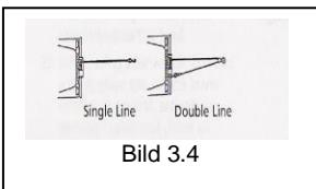
Om belastningen är 70 % över den nominella kapaciteten rekommenderar vi att du använder talja eller hjälpblock så att vajern är dubbel. Bild 3.4
