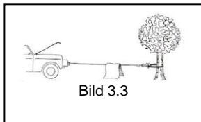
Placera en filt eller jacka över vajern 1,5-1,8 meter från kroken vid tung belastning. Filten gör så att studsen från en bristande vajer dämpas. Du får extra skydd genom att ta upp fordonets motorhuv enligt bild 3.3.
