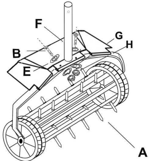
1. Kiinnitä runko (A) putkeen (F) ruuveilla (B). Varmista, että kaikki kiinnikkeet on kunnolla kiinni.
