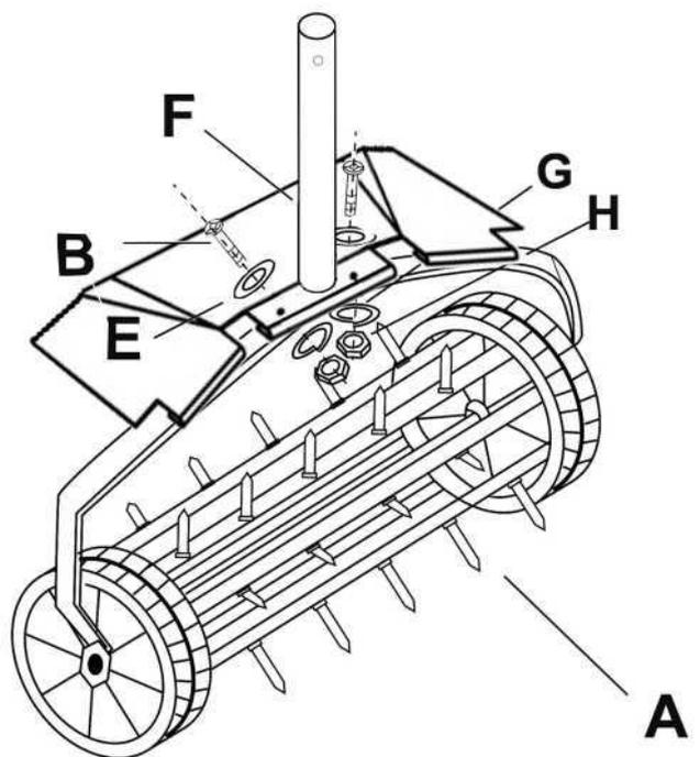
1. Montera ram (A) i rör (F) med skruvar (B). Se till att alla fästen sitter ordentligt.
