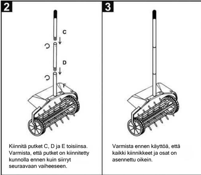
Kiinnitä putket C, D ja E toisiinsa. Varmista, että putket on kiinnitetty kunnolla ennen kuin siirryt seuraavaan vaiheeseen.
