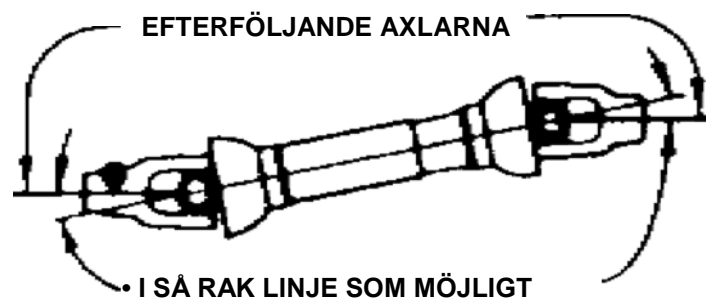
Bild 2 – Granskning av kraftuttagsaxelns
