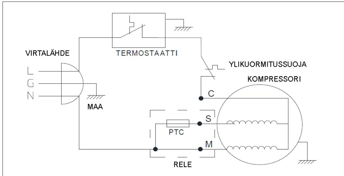
*Huomaa: Kompressoria ei välttämättä ole varustettu käyttökondensaattorilla kompressorin todellisen mallin mukaan.*
