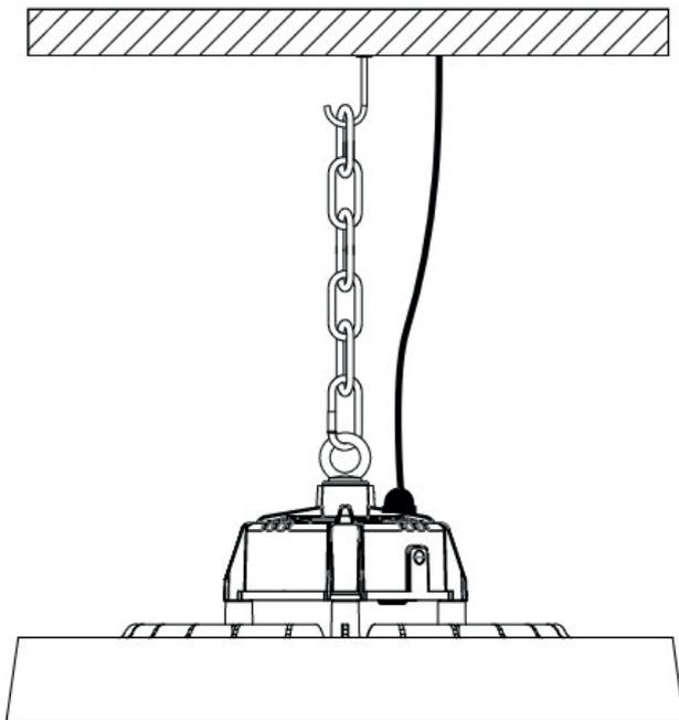
Kun valaisin on asennettu edellä kuvatun mukaisesti kattoon, voidaan tehdä valaisimen sähkökytkennät. Kytkennät saa tehdä ainoastaan henkilö, jolla on asennukseen soveltuva osaaminen. Tarvittaessa käänny asennuksessa pätevyystodistuksen omaavan sähköasentajan puoleen. Kun asennus on valmis, varmista että virtajohto ei ole jäänyt liian kireälle. Mikäli virtajohto on pingottunut kireälle, nosta valaisinta lähemmäksi kattoa, kunnes johto ei ole kireällä. Oheisessa kuvassa oikein asennettu valaisin.
