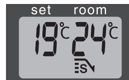
J: Kun SAVE-valo syttyy, lämmitin menee automaattisesti päälle tai kytkeytyy automaattisesti pois päältä niin, että lämpötila pysyy määritetyllä välillä.
