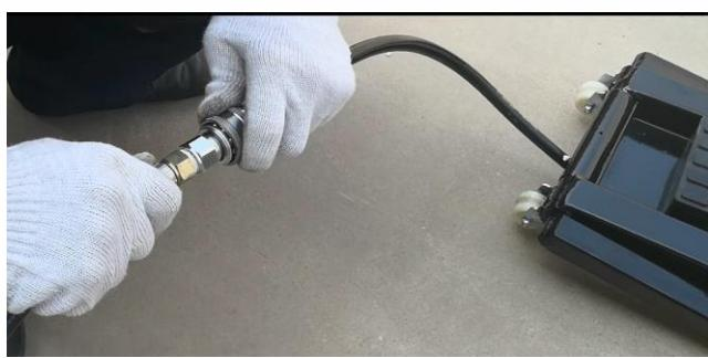
Käännä nostin ylösaisarin. Kytke voimayksikkö päälle. Kytke pistoke 230 V / 50 Hz pistorasiaan. Paina ylös-painiketta, kunnes nostin on yläasennossa. Paina alas-painiketta, kunnes nostin on ala-asennossa. Toista tämä 2-3 kertaa. Poista ilma letkusta ja sylinteristä (sylinteri lakkaa liikkumasta hitaasti). Käännä nostin oikein pään.
