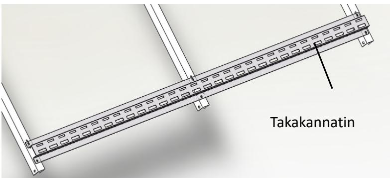
8. Kiinnitä keräimen jakotukki etujalkojen yläosaan.
