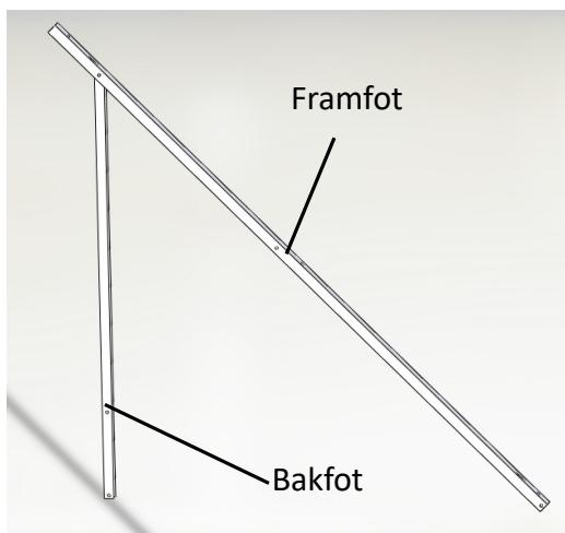
2. Montering av stödet: Fäst stödet på framfoten och bakfoten med en M8x25-skruv.
