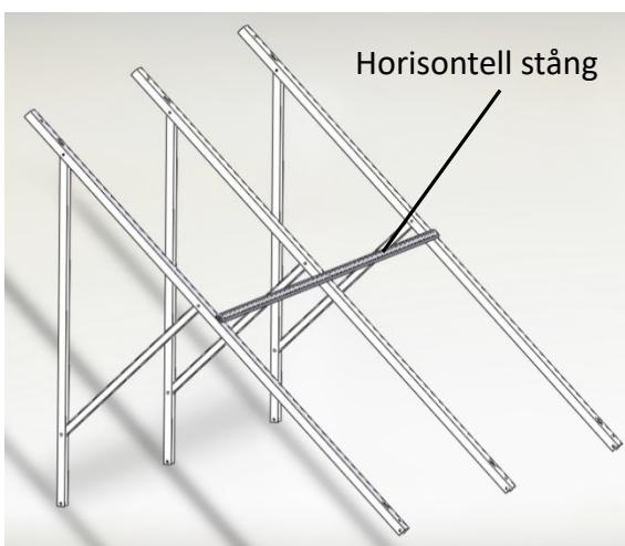
5. Rikta in de två hålen i tvärstödet och fäst dem med M8x25-bultar.
