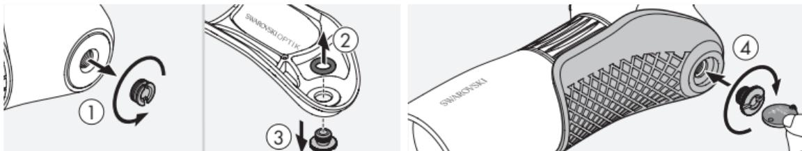
Passaggio 3: Fissate il semiguscio alla parte inferiore del telescopio avvitando la vite di bloccaggio.
