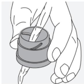
Das Gehäuse pflegen Sie am besten mit einem weichen, feuchten Putztuch (bitte verwenden Sie dazu nicht das Reinigungstuch). Bei starker Verschmutzung (z.B. Sand) sind die Drehaugenmuscheln komplett abschraubar und somit sehr einfach zu reinigen.
