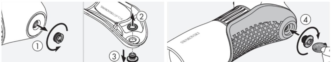
Trin 3: Fastgør halvskallen til bunden af teleskopet med låseskruen.
