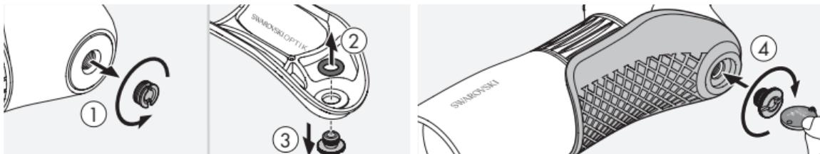
Stap 3: Zet de halve schaal vast aan de onderkant van de telescoop met de borgschoef.
