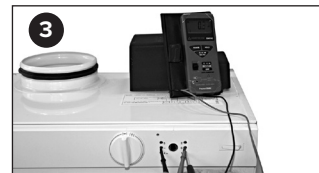
Mittaa jännite navoista – ja S, säädä esim. nopeus 1 potentiometriltä 1
